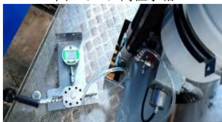
图 13-44 安装气密性测试装置
