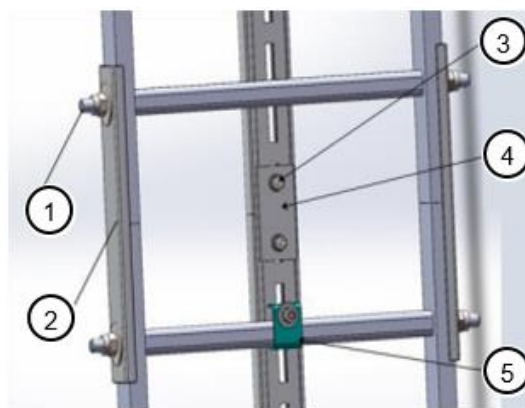
图 9-20 安装 R5 型爬梯导轨
