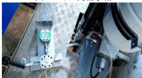
图 12-36 安装气密性测试装置
