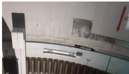
图 15-24 叶片变桨至 30 度位置状态
